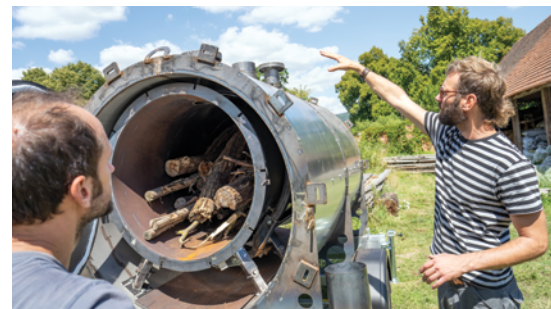
Dvouplášťový dávkový systém na výrobu biouhlí, foto: Karolína Poláčková.
